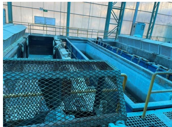
Hình 3.6. Hệ thống thu gom hơi hóa chất khu vực tẩy rửa bề mặt trước khi mạ
