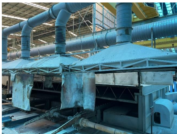
Hình 3.10. Hệ thống xử lý bụi tại công đoạn mạ kẽm nhúng nóng
