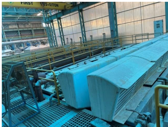
Hình 3.6. Hệ thống thu gom hơi hóa chất khu vực tẩy rửa bề mặt trước khi mạ
